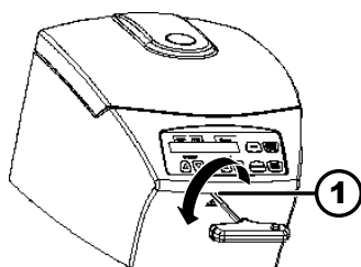
Fig. 16: Sblocco di emergenza
