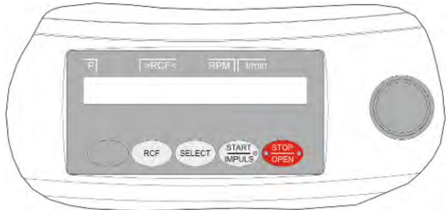
Abb. 3: Steuerung (Gerät ohne Kühlung)
