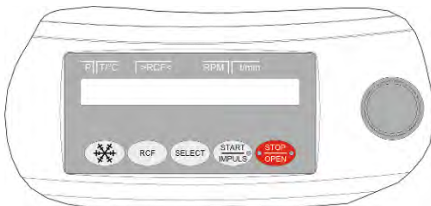
Abb. 2: Steuerung (Gerät mit Kühlung)
