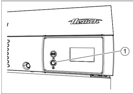
Fig. 54: Device switch
