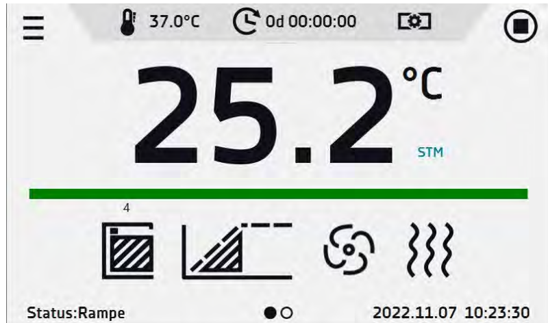
Abb. 54: Option aktiviert (Temperaturüberwachung), das Programm läuft.
